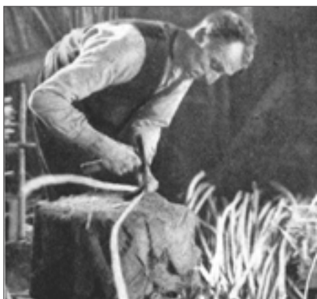
Hier vervaardigt men de hoepels, die om houten latjes worden gelegd. Een van de eerste bewerkingen is het splijten, met behulp van een zoogenaamde dissel, van de geschilde teen.
