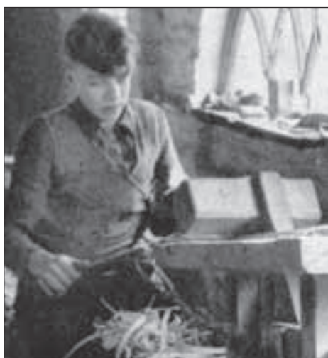
Jong en oud kan men in de hoepelmakerij gebruiken. Deze jongeman werkt aan de snijbank; met een scherp mes schaaft hij alle oneffenheden van de teen, zoodat deze glad en buigzaam wordt.
