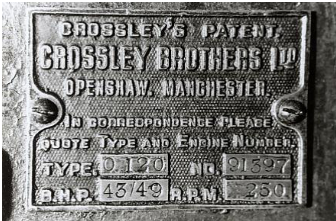
Afbeelding 6. Plaat op de ruwoliemotor met vermelding van de fabrikant, type, het typenummer en de omwentelingssnelheid. (foto: André Tukker)
