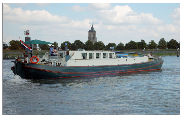
Na ombouw tot recreatievaartuig is het als 'Obelisk' ingeschreven en heeft thans ter voortstuwing een Daf dieselmotor van 120 pk.
